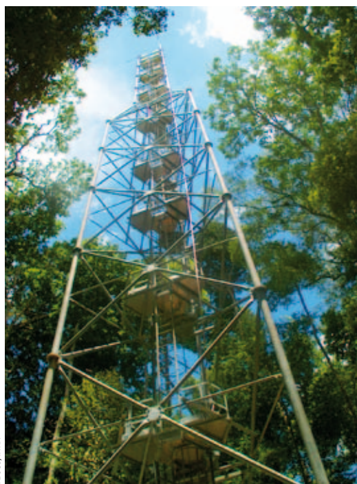
Les capteurs situés au sommet de cette tour haute de 55 mètres dépassent la canopée de la forêt guyanaise. Ils permettent de mesurer les flux de dioxyde de carbone et de suivre si l'écosystème gagne ou perd du carbone au fil du temps.
